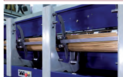
Inserstion du faisceau de barre de la boite par le haut
